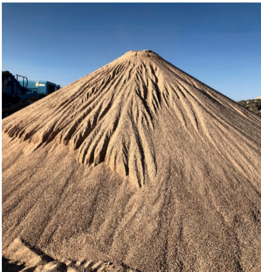
Ilustración 7 Acopio arena reciclada 0.8mm AR-Mixto.
