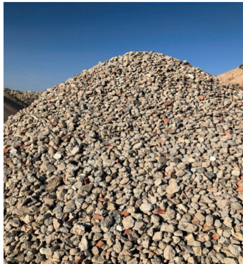
Ilustración 2 Corte acopio 20-32 para producción de AR-Hormigón.
