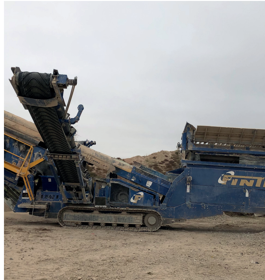
Ilustración 16 Criba empleada para la producción de arenas recicladas.
