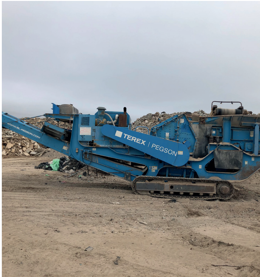
Ilustración 15 Molino empleado para la producción de arenas recicladas.
