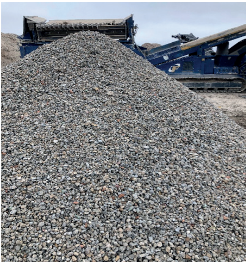
Ilustración 13 Acopio de Hormigón Plus ARM 8-20.
